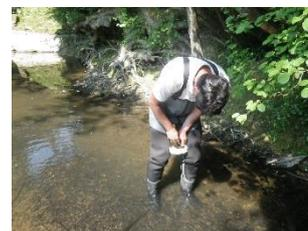
Le matériel benthique est récupéré par brossage de substrats durs naturels, mis dans des piluliers, alcoolé in situ. Les récoltes ont été dûment étiquetées et apportées au laboratoire Bi-Eau à Angers qui est chargé de la détermination et de l'analyse de ces prélèvements.
